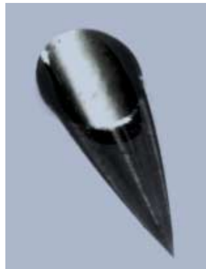
trace (ligne oblique en pointillés), laissant un trou conique (au centre). Le trou (à droite) de un millimètre de long dans du polycarbonate Lexan embarqué à bord d'Apollon 14 reflète le passage d'un noyau d'argon.
