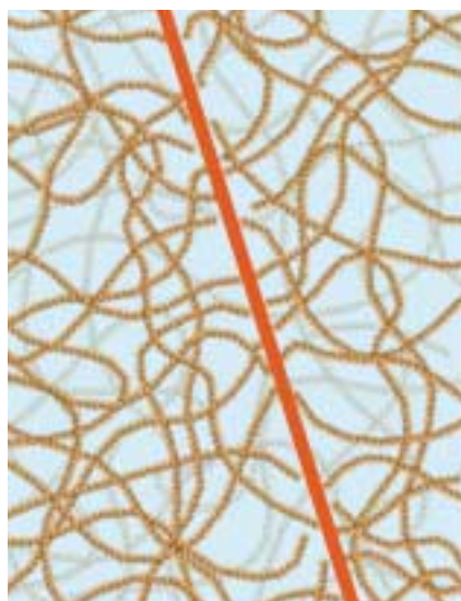
2. LE PASSAGE DES PARTICULES CASSE LES CHAÎNES de polymère d'un plastique, formant un étroit couloir (ligne rouge, à gauche). En traitant avec une base forte, on attaque le matériau le long de cette
