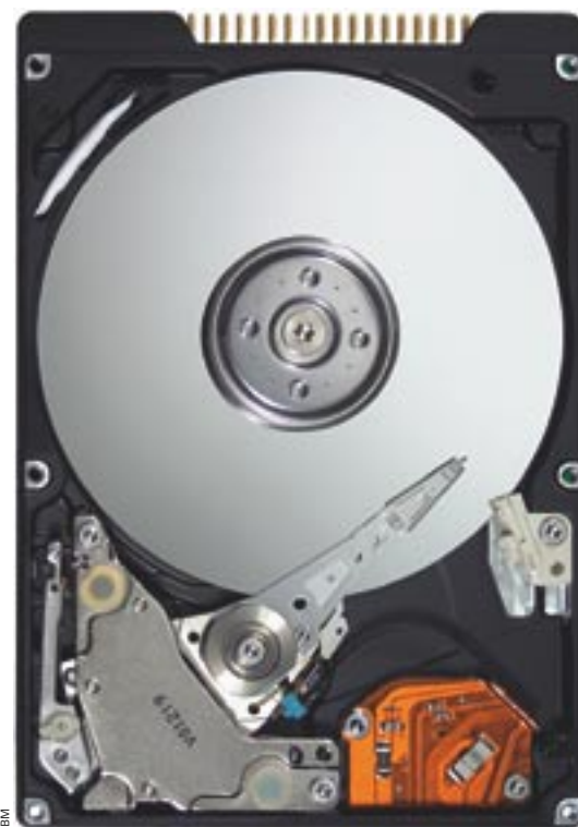
▲ Eine moderne Festplatte aus der Serie »Travelstar« von IBM/Hitachi in Originalgröße. Die einzige Platte des Geräts ist aus Glas, hat einen Durchmesser von 6,3 Zentimetern und ist sandwichartig beschichtet: eine Lage Ruthenium zwischen zwei antiferromagnetischen Schichten. Sie speichert 15 Gigabyte bei einer Dichte von 4 Gigabit pro Quadratzentimeter. Die digitalisierte Version dieses Fotos würde lediglich einen Quadratmillimeter der Plattenoberfläche in Anspruch nehmen.
